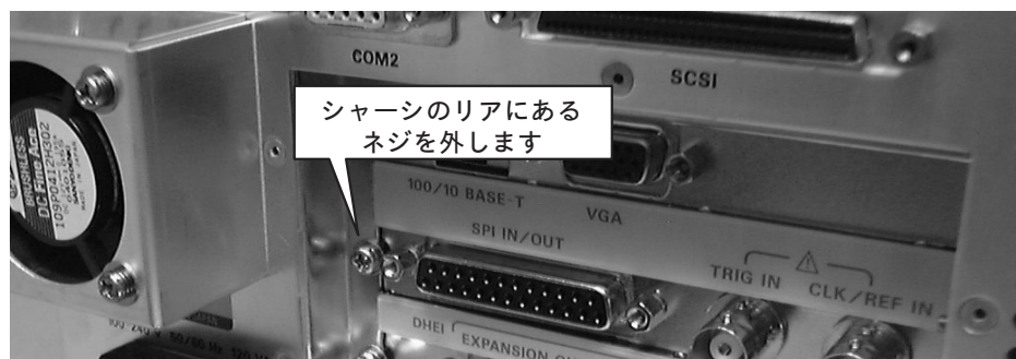
図5：シャーシのリアにあるネジの取り外し
